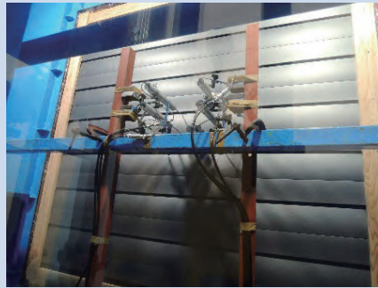
金属板ぶきの耐風圧性試験
