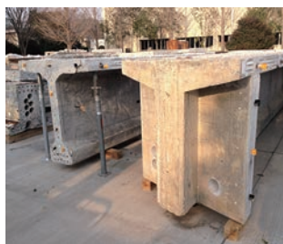
撤去部材より切出した供試体
