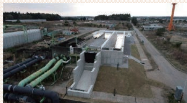
大規模堤防模型実験水路
