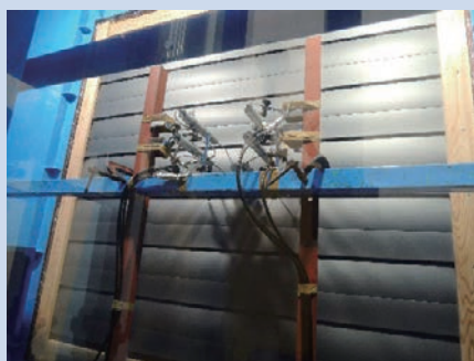
金属板ぶきの耐風圧性試験
