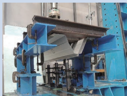
折板ぶき接合部の載荷試験
