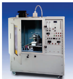
図-3 SDC試験装置 2)
