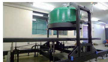
竜巻状気流発生装置 (国研)建築研究所所有
