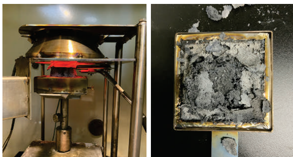
写真 ガス成分分析法による試験の例（塩ビ樹脂）
