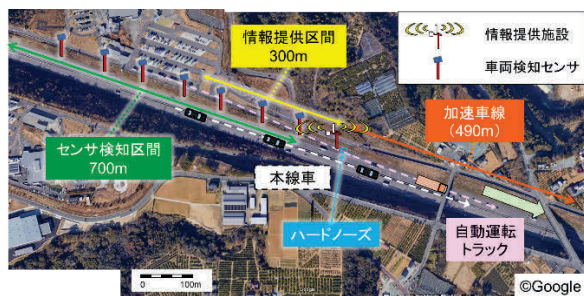
図-2 機器配置レイアウト（浜松SA（上り））
