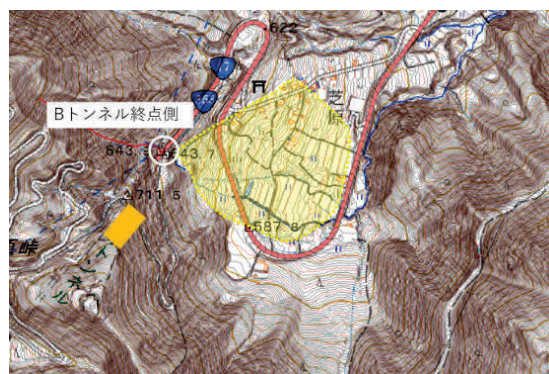
図-4 地形判読による沖積錐（土石流堆）の分布範囲
