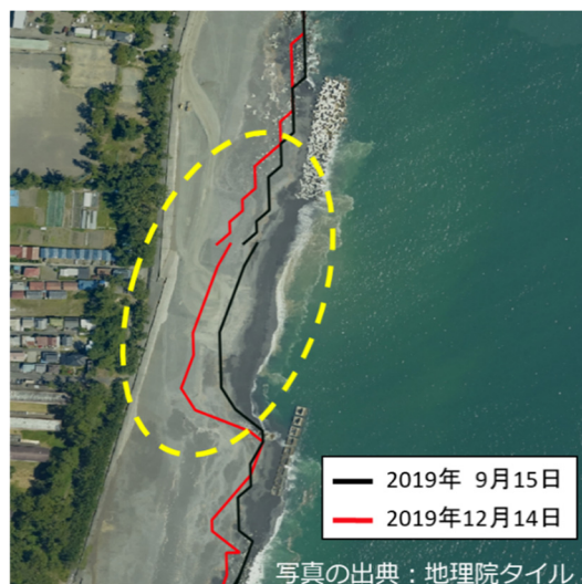
図-3 10月に通過した台風による大規模な海岸侵食前後に撮影された衛星画像からの海岸線抽出結果。黄色で囲った箇所では、台風後に侵食が確認されている。
