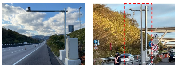
図-1 合流支援情報提供のための実験機器 (左：車両検知センサ、右：情報提供施設)
