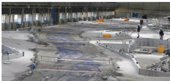
写真 河道の二極化プロセスの把握を目的とした水理模型実験
