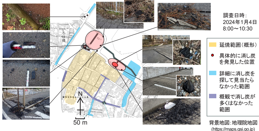
図-2 火の粉の飛散状況
