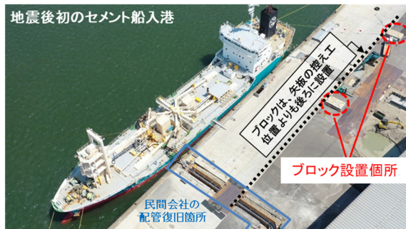
金沢港御供田1号岸壁の仮設係船柱(ブロック)の設置に関する技術支援
