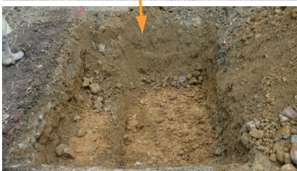
ダム天端舗装面クラック箇所での開削調査（堤体内に損傷なし）
