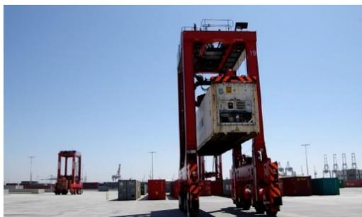
図 LA港のオートストラドルキャリア：フィンランド製シャトルキャリアによる無人搬送システム
