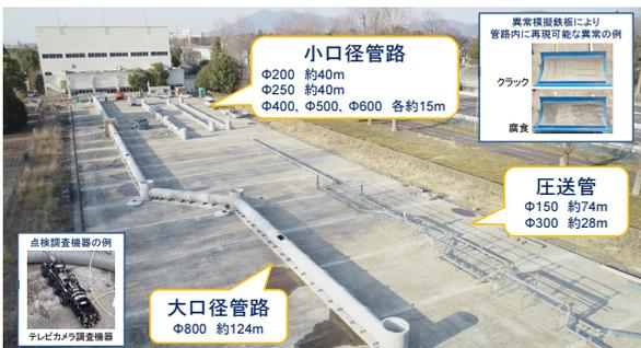
図-1 下水道管路模擬施設の俯瞰図
