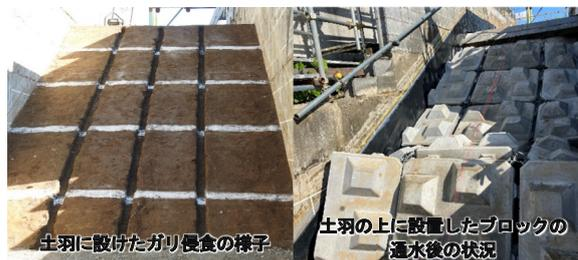
写真-3 土羽にガリ侵食等を設けた実験の様子
