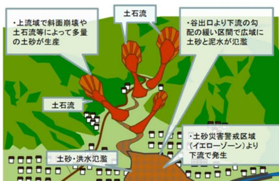
図-1 土砂・洪水氾濫のイメージ
