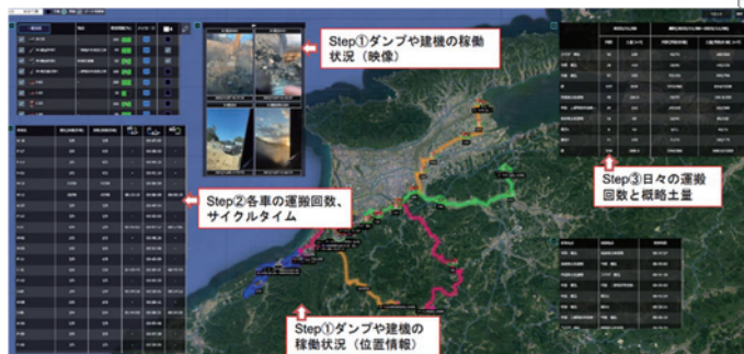
図-3 松江国道事務所での土配モニタリング試行例
