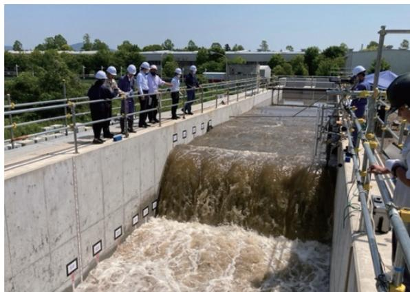
写真-3 大規模実験施設による実物大の越流実験
