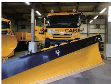
写真-1 空港除雪車両の例(プラウ除雪車両)
