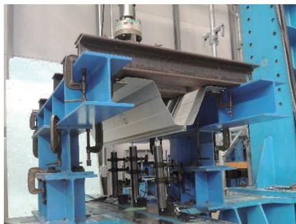
写真-2 折板ぶき接合部の引張り載荷試験の実施例
