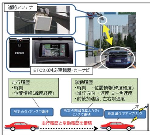
図-1 ETC2.0プローブ情報の収集
