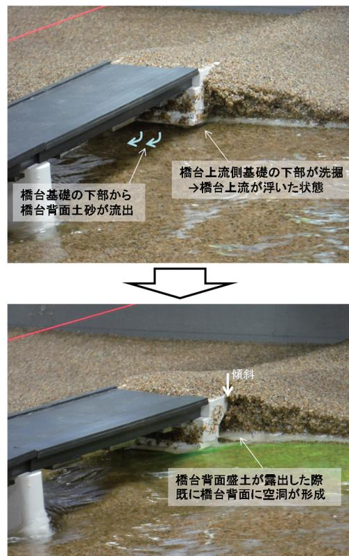
図4 橋台下面からの吸い出しによる橋台背面の空洞化
