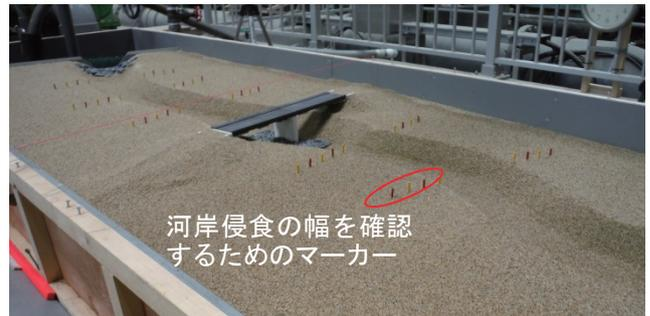
図1 移動床模型全景
