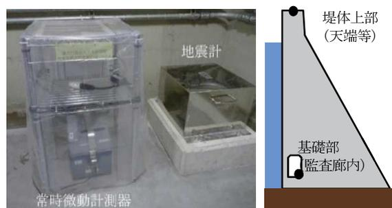
図-1 地震計・常時微動計測器と計測箇所例
