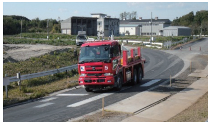
電線等を埋設した舗装における車両走行実験
