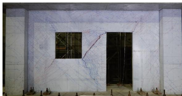
写真3 変形角1/100rad時の損傷状況
