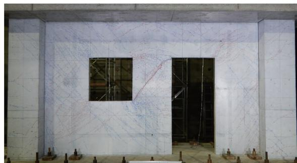
写真2 変形角1/200rad時の損傷状況
