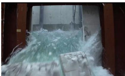
写真1 外壁材の水理実験
