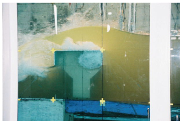
写真－2 道路橋における波力実験
