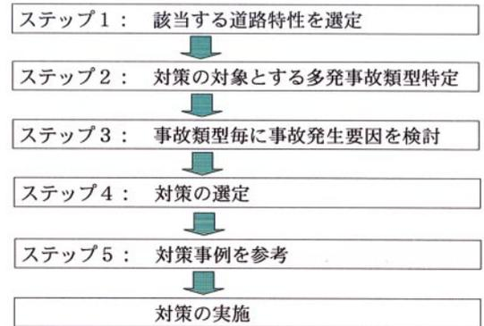
図-4 交通安全対策事例集（仮称）を使用した対策の検討ステップ
