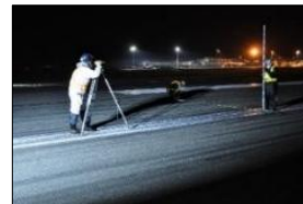
勾配の計測方法（水準測量）
