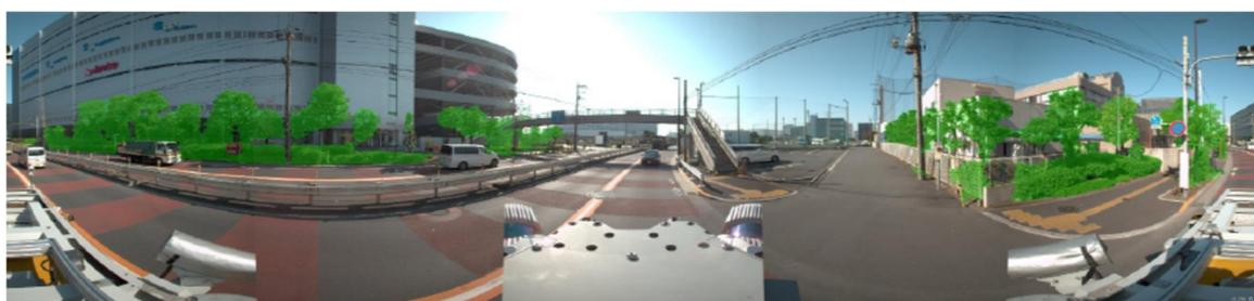
水平 360 度画像（道路調査用の MMS : Mobile Mapping System による撮影）
