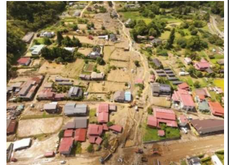
山地流域で発生した土砂の 下流河川における堆積と氾濫 (長野県茅野市)
