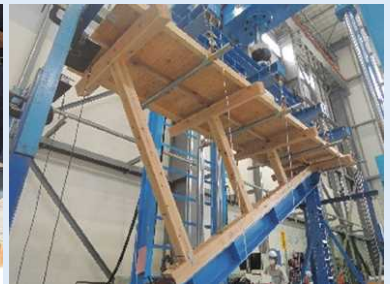
屋根瓦と木造小屋組の载荷試験
