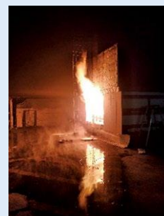
上階延焼防止対策の実験
