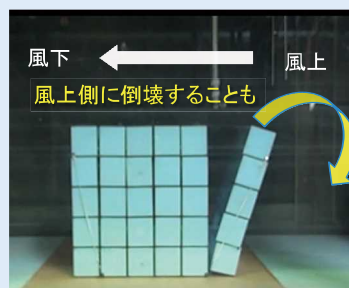
〈コンテナ模型の風洞実験〉
