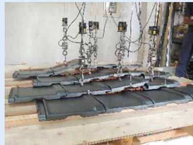
屋根瓦と木造小屋組の载荷試験
