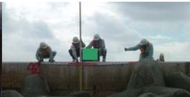
消波工の点検状況（沈下量測定）
