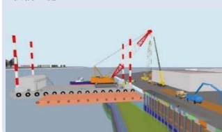
< 栈橋の施工シミュレーションモデルのイメージ >
