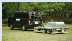
空洞探査(実証中)
