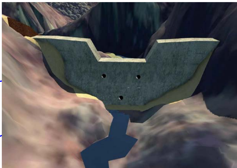
砂防構造物CIMモデルの構造例
