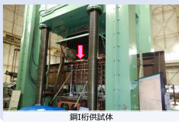
鋼I桁供試体
