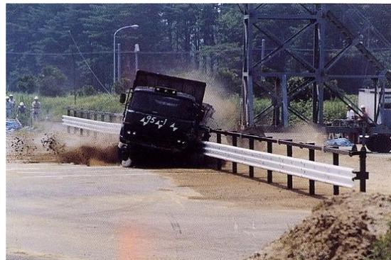
写真-3 大型貨物車の衝突実験
