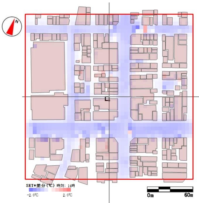
人体の熱収支モデルを用いて、体感温度（人が感じる温度）を数値化することができます。幹線道路等を保水性舗装にすると、体感温度が1~2℃低下することがわかります。
