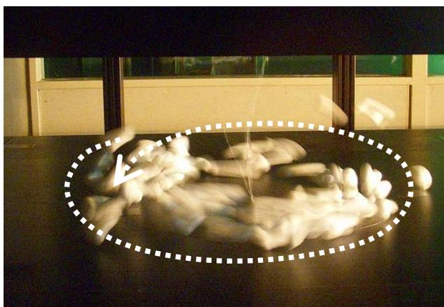
軽量の飛散物モデルを用いて物体が実際に飛散している状況を再現することにより、実験的に衝撃リスクを評価することができます。
