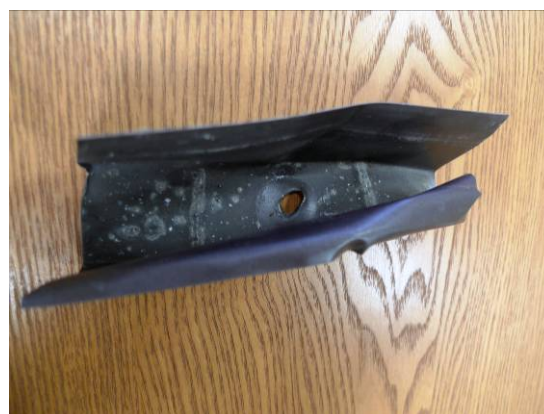
写真5 飛来物（瓦棒ぶきの部分吊子と思われる）
