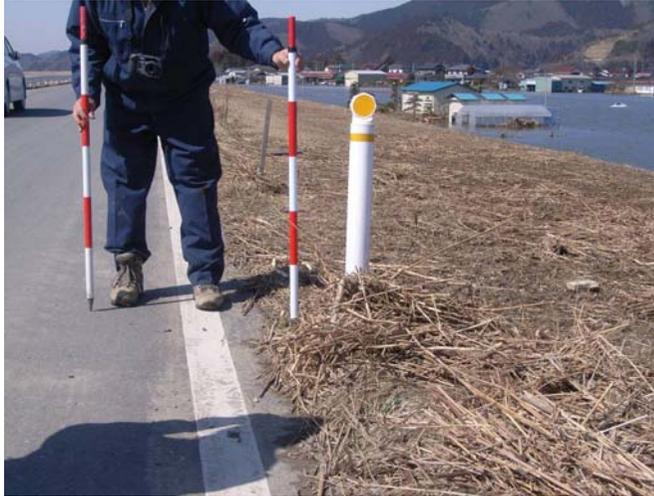
◆天端の水位痕跡：天端上 20cm 程度の水位と推定される
