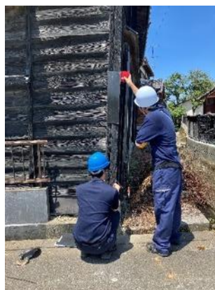
写真 6.2.10 残留変形 81/1000=1/12\text{rad}
