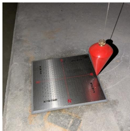
図 4.2.3-3 下げ振りによる残留変位の計測
