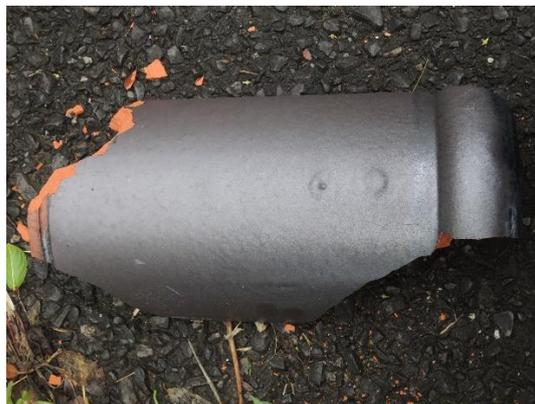
写真 3.4 脱落した棟瓦の状況
