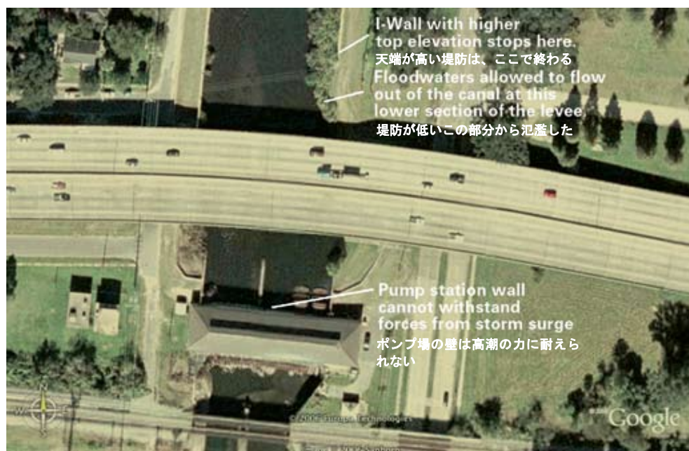
図-8.2 Orleans Canal の第7 ポンプ場
