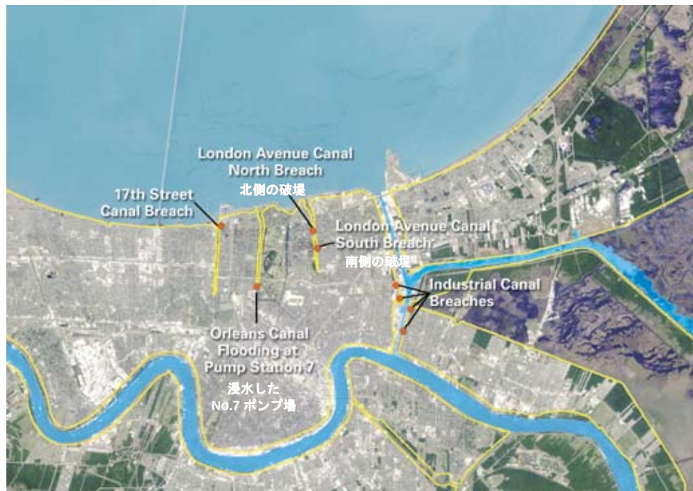
図-5.3 ニューオーリンズハリケーン防御システムの主な破堤
