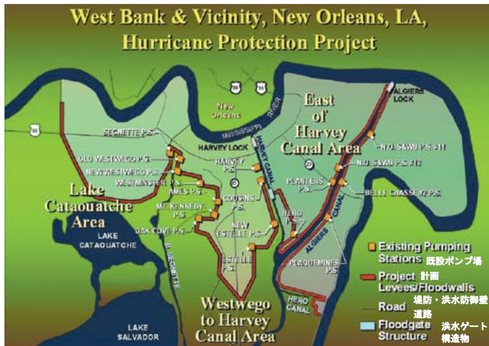
図-4.3 ルイジアナ州ニューオーリンズ西岸および近郊ハリケーン防御システム
