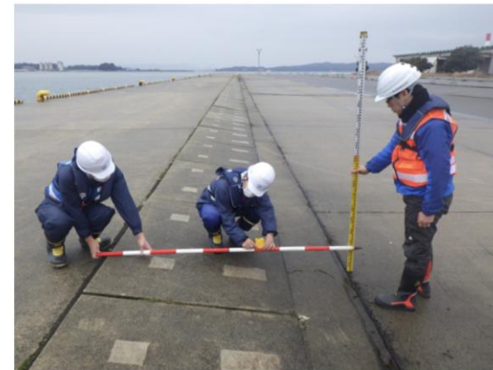
参考資料 写真 4-2 栈橋背後の渡版の傾斜とその調査
