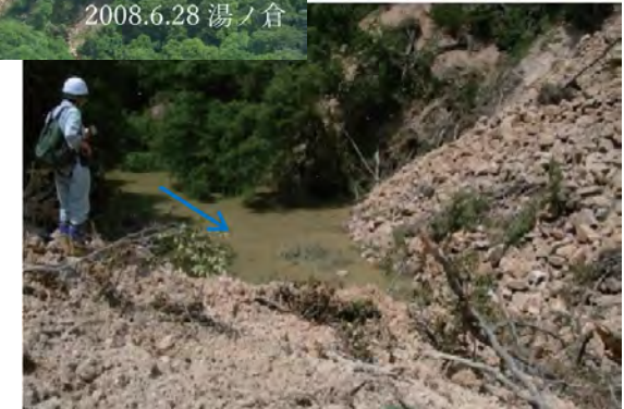
土砂災害研究部による河道閉塞(天然ダム)の現地調査(2008年岩手・宮城内陸地震)
