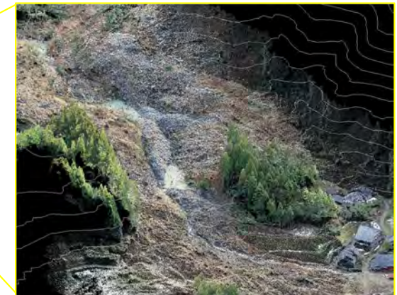
北陸地整TEC-FORCE撮影のUAV 画像から作成したBIM/CIMモデル
