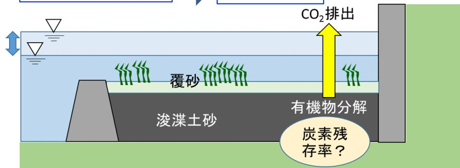
$$\text{炭素残存率} = \frac{\text{現状の浚渫土砂中の全有機炭素量(TOC)(mg/g)}}{\text{施工時(浚渫時)の浚渫土砂中の全有機炭素量(TOC)(mg/g)}}$$
