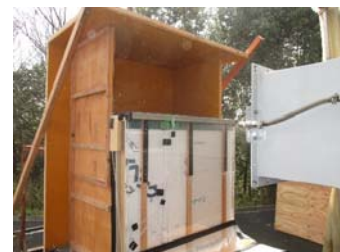
通気構法の外壁への送風散水試験
