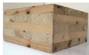
CLT詳細写真
