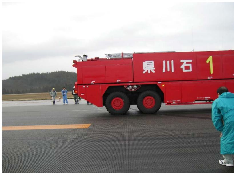
大型消防車を用いた支持力調査
