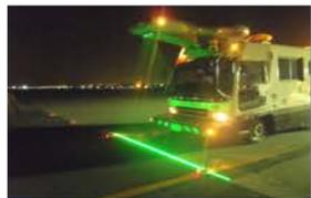
路面性状測定車による舗装表面の点検
