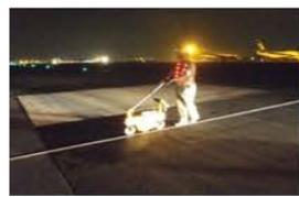
小型プロファイル測定装置によるわだち測定
