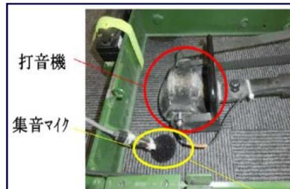
写真：測定車の集音計等及びソノグラフ、異音マップ図
