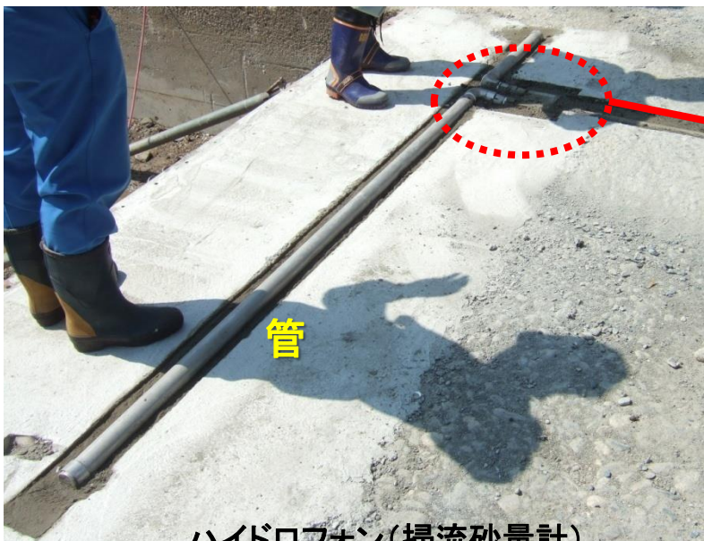
ハイドロフォン(掃流砂量計)
