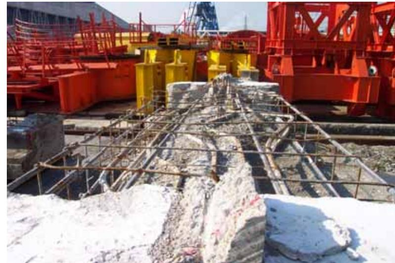
写真。工業倶楽部ビル建て替え解体時に切り出された被災した柱:主筋が曲がっているのが認められる。(2001年1月11日撮影;清水建設協力)
