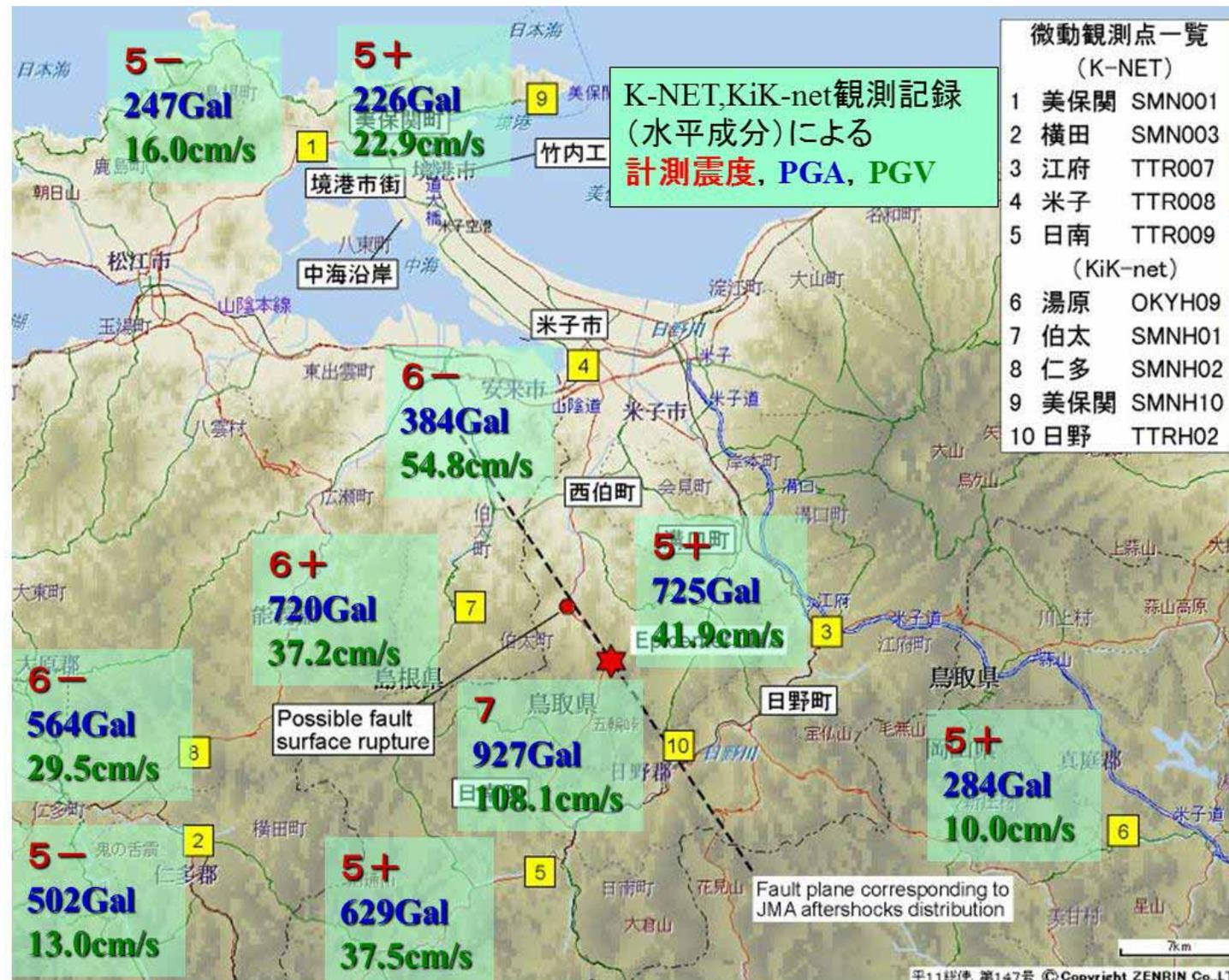
図 直下地震である鳥取県西部地震による地震動の最大値分布. (EdM[防災科学技術研究所地震防災フロンティア研究センター]研究会資料より転載)
