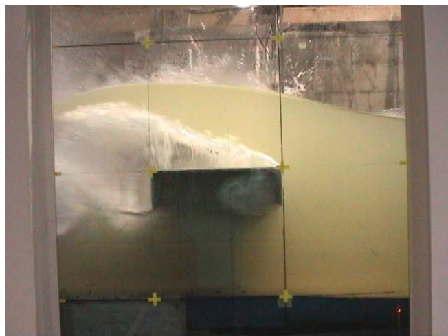
橋桁模型に衝突する波
