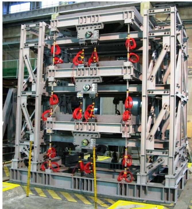
ねじれ振動の評価に関する振動台実験
