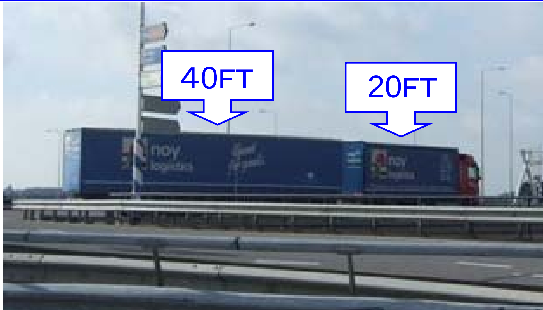
20ftコンテナ＋40ftコンテナ搭載フルトレーラ
