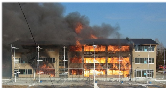
実物大建物の火災実験
