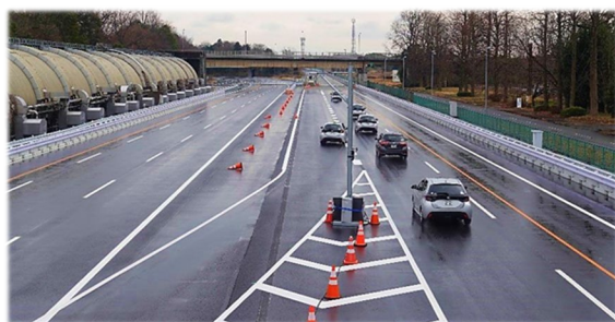
合流支援情報提供システム検証実験（自動運転）
