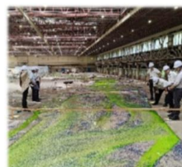
リアル空間の河川の実験場 （河川模型実験施設）
